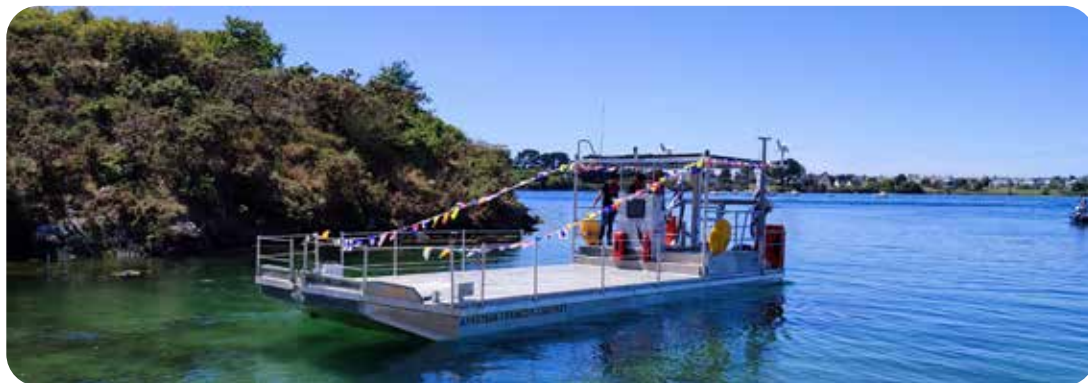
Les équipements photovoltaïques et éoliens de la barge François Cadoret, prototype construit en 2022 par le CRC* Bretagne-Sud, assurent l'indépendance énergétique de son fonctionnement (batteries, projecteur, GPS, etc.). © CRC Bretagne-Sud
