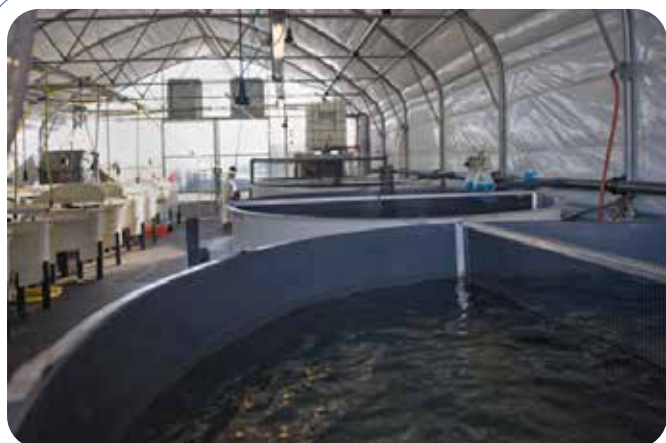
Serre expérimentale permettant d'exposer des organismes marins à différents types de produits polluants. © Laurent Mignaux / Terra
