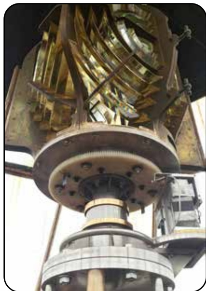
L'optique et le système de rotation
