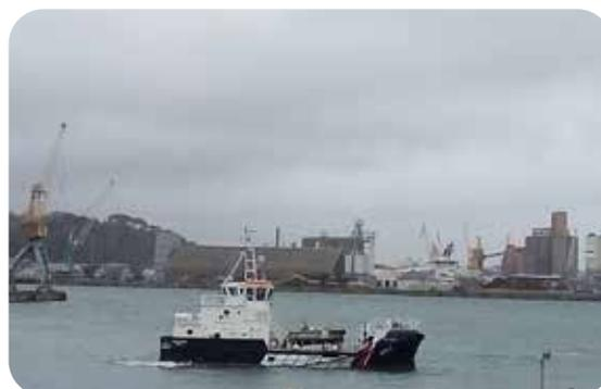
Le baliseur Finistère de l'APB (Armement des Phares et Balises) permet à la DIRM NAMO d'entretenir les aides à la navigation de la baie de Morlaix à la mer d'Iroise (cf page 74). Construit par le chantier Gléhen du Guilvinec, il est équipé d'une propulsion électrique pour les zones abritées et ses manœuvres portuaires.
