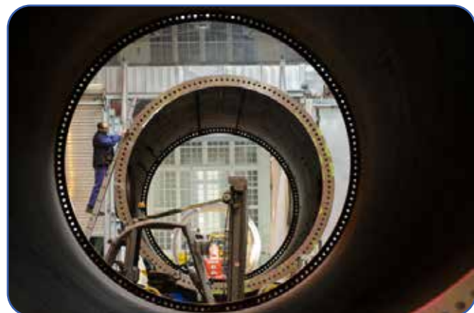
Contrôle de qualité effectué lors du processus d'assemblage du mât d'une éolienne
