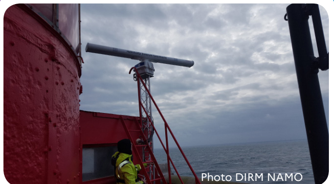
Photo DIRM NAMO Radar couplé avec deux caméras dont l'exploitation des données par croisement participe à la modélisation en 3D des houles déferlant aux abords du phare de La Jument.
