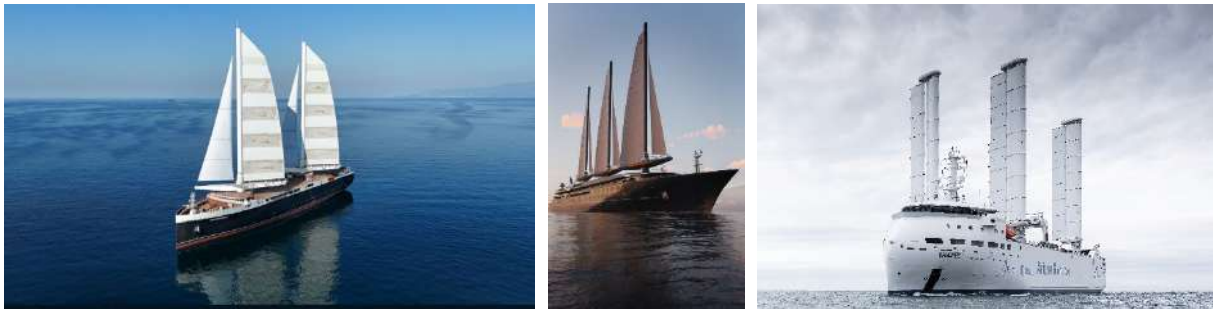
De gauche à droite – Neoliner Origin, Ro-Ro de 136m, 6300 dwt, SolidSail (nouvelle construction) - @RMK Marine ; Orient Express Silenseas, paquebot de 220m, 22 300 UMS, SolidSails by Chantiers de l'Atlantique (nouvelle construction) - @Orientexpress ; Canopée, Ro-Ro de 121m, 5 400 dwt, OceanWings (nouvelle construction) – @Tom Van Oossanen.
