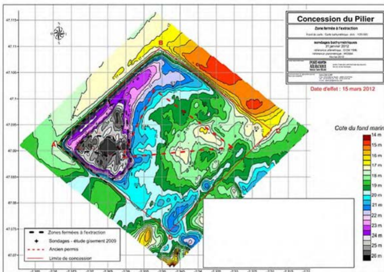
Figure 4 : Bathymétrie de la concession du Pilier au 15 mars 2012 (Carte de sondages bathymétrique – Port Autonome Nantes/Saint-Nazaire, GEOSCOPI)
