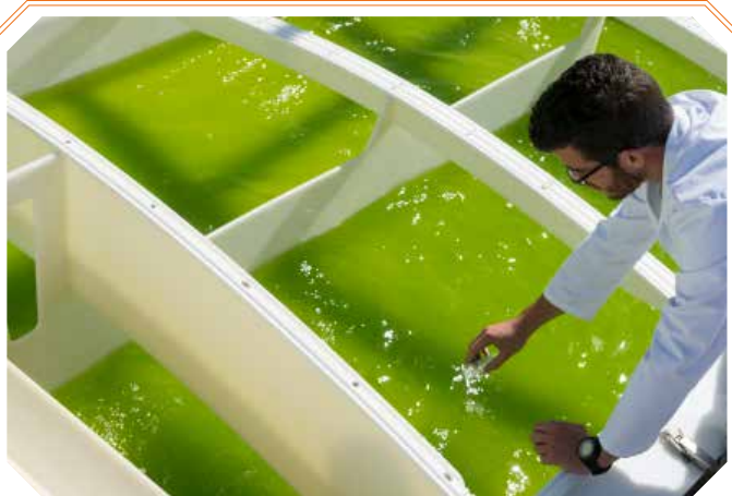
Prélèvement de microalgues Nannochloropsis mise en culture dans un bassin extérieur Raceway © Jean-Claude MOSCHETTI/AlgoSolis/CNRS Photothèque
