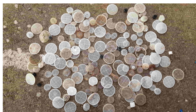
Bio media utilisé pour traitement des eaux usées
